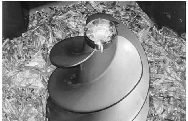
Figura 10. Hidrapulper antes da desagregação do papel. Figura 11. Hidrapulper após a desagregação.
